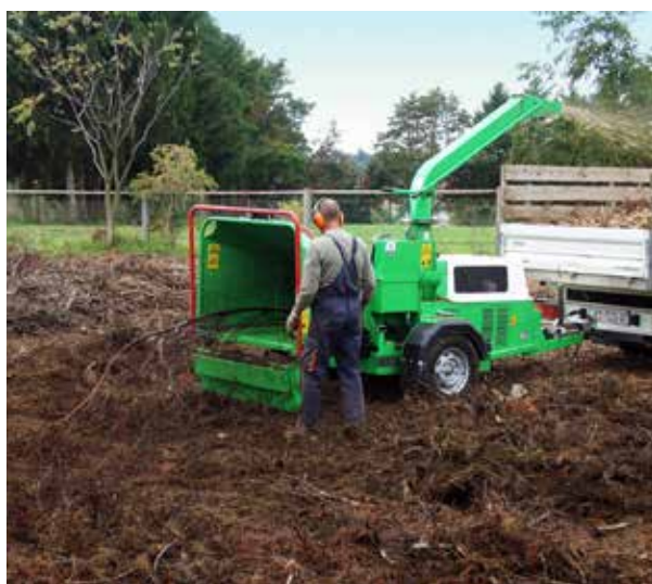
Prije kompostiranja granje se strojno usitnjava – sječkalica
