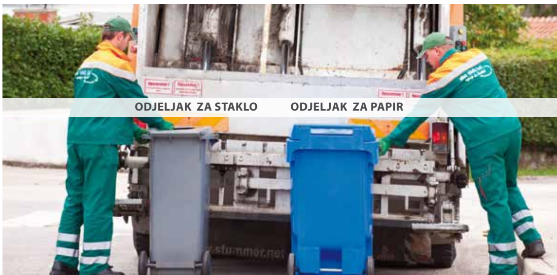
Kamion s dvije odvojene komore u teretnom prostoru za istovremeno sakupljanje papira, plastike ili drugih frakcija. Na ovaj način smanjuju se troškovi prijevoza otpada.
