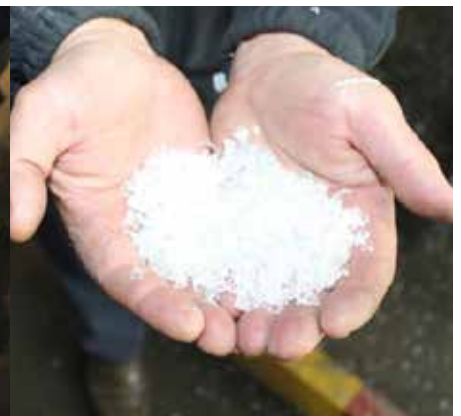
Usitnjavanjem stare plastične ambalaže dobiva se granulat (na slici) čijim topljenjem i ponovnim oblikovanjem dobivamo potpuno nove proizvode.
