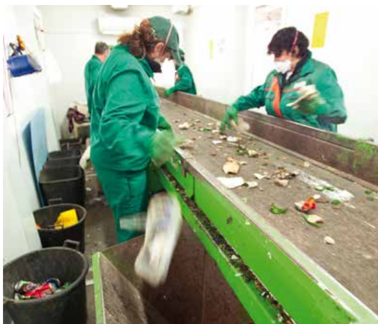
Otpad u sortirnici prolazi pokretnom trakom gdje radnici i radnice odvajaju pojedine korisne frakcije i ubacuju ih u svoje priručne spremnike. Netko odvaja papir, netko određene vrste plastike itd.
