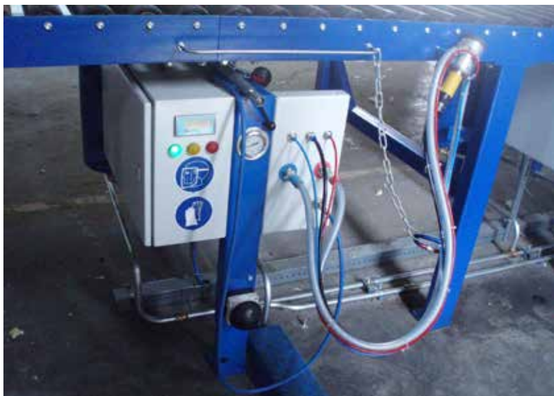
Uređaj za sigurno uklanjanje freona iz sustava za hlađenje BEZ OVOG UREĐAJA POSTUPAK RASTAVLJANJA SUSTAVA ZA HLAĐENJE OPASAN JE ZA ZDRAVLJE I ŠTETAN ZA OKOLIŠ!
