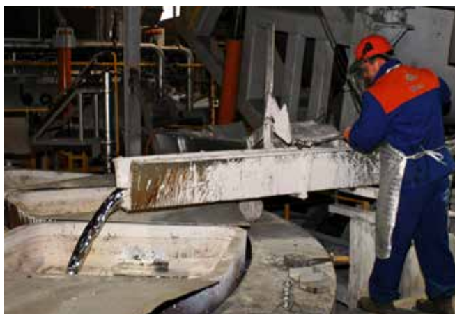
Ispuštanje lijeva iz peći
