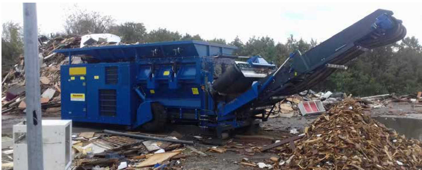
Drveni otpad usitnjava se specijalnim strojevima
