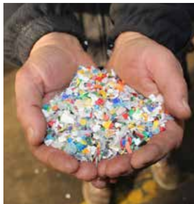
Usitnjavanjem stare plastične ambalaže dobiva se granulat (na slici) čijim topljenjem i ponovnim oblikovanjem dobivamo potpuno nove proizvode.
