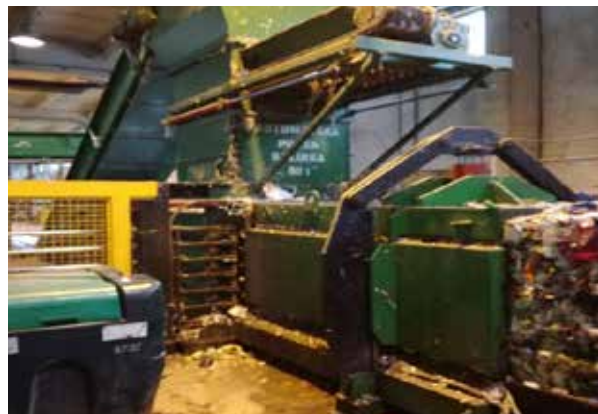
Dodatno sortirani otpad preša se i pakira u tzv. bale radi transporta do oporabitelja.
