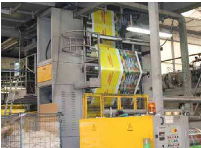
Granulat se topi na visokoj temperaturi i od njega se proizvodi nova folija.
