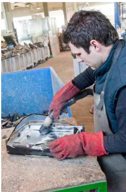
Odstranjivanje fosfora s unutarnje stjenke tv ekrana
