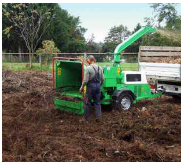
Prije kompostiranja granje se strojno usitnjava - sječkalica
