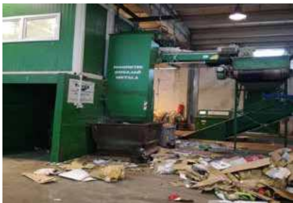
Ne razvrstava se sav otpad ručno: u nekim sortirnicama metal se odvaja magnetom.
