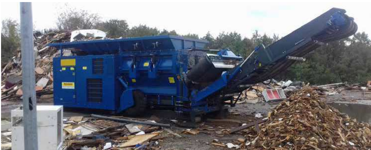
Drveni otpad usitnjava se specijalnim strojevima
