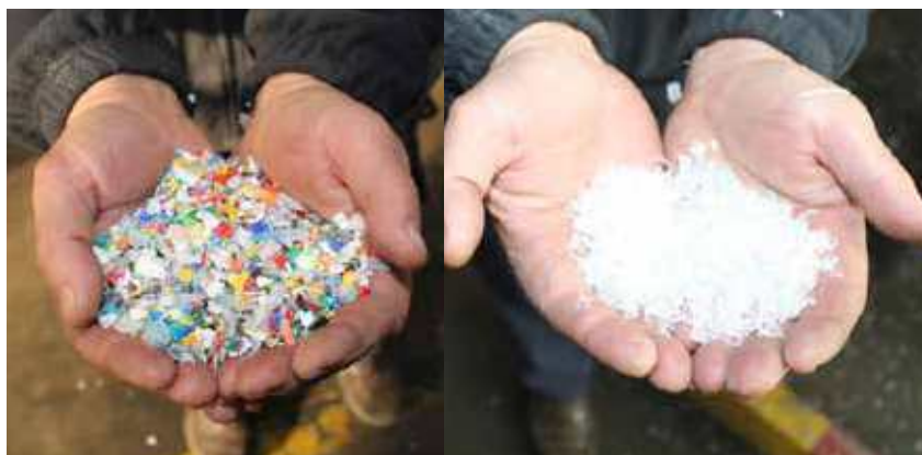
Usitnjavanjem stare plastične ambalaže dobiva se granulat (na slici) čijim topljenjem i ponovnim oblikovanjem dobivamo potpuno nove proizvode.
