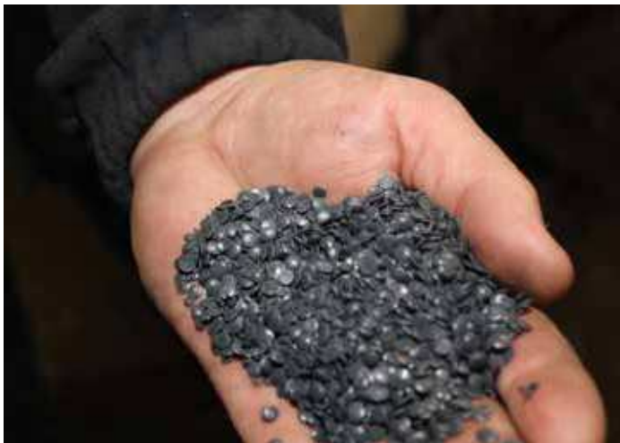
Granulat nastao usitnjavanjem otpadnog polietilena
