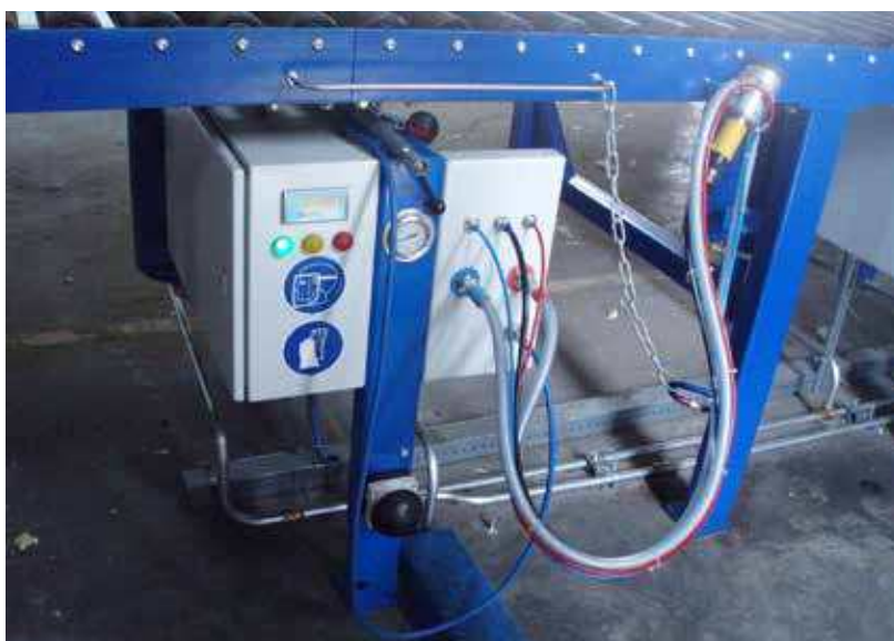
Uređaj za sigurno uklanjanje freona iz sustava za hlađenje BEZ OVOG UREĐAJA POSTUPAK RASTAVLJANJA SUSTAVA ZA HLAĐENJE OPASAN JE ZA ZDRAVLJE I ŠETAN ZA OKOLIŠ!
