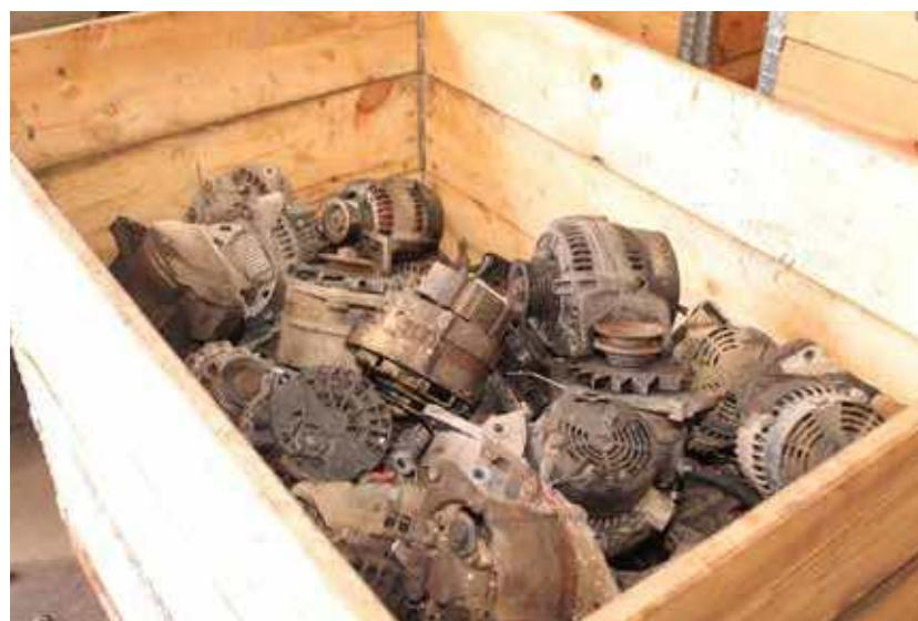
Komponente koje se mogu ponovno iskoristiti (npr., automobilski alternator, anlaser ili kočione čeljusti) se izdvajaju pa se nakon postupka obnove („repariranja“) ponovno koriste kao zamjenski dijelovi za vozila koja su još u upotrebi.
