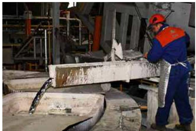
Ispuštanje lijeva iz peći
