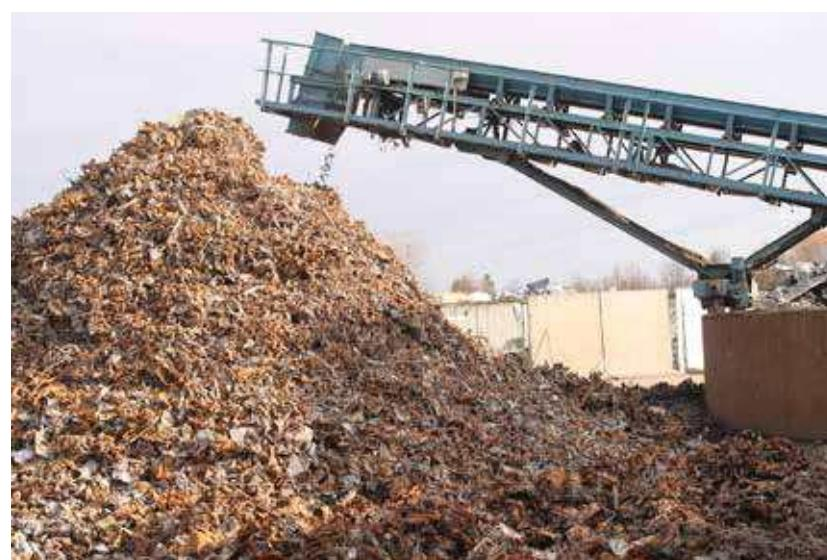
Otpriklike 60 % ukupne mase automobila čini čelični lim. Na slici je prikazana završna frakcija lima iz postupka drobljenja. Lim nakon drobljenja odlazi u ljevaonice i željezare kao sekundarna sirovina te se od njega rade poluproizvodi (ingoti).
