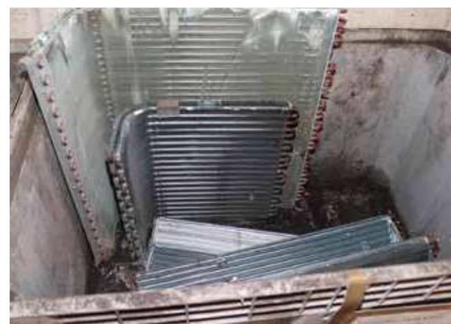
Na slici su prikazani bakreni i aluminijski dijelovi iz rashladnih uređaja koji se koriste kao sekundarna sirovina u tzv. rafinerijama obojenih metala. Upravo su ovi dijelovi razlog zbog kojeg neovlašteni i ilegalni sakupljači uzimaju otpadnu tehniku (hladnjake i klima uređaje). Rastavljanjem ovih uređaja bez adekvatnog alata dolazi do nekontroliranog ispuštanja freona u atmosferu.
