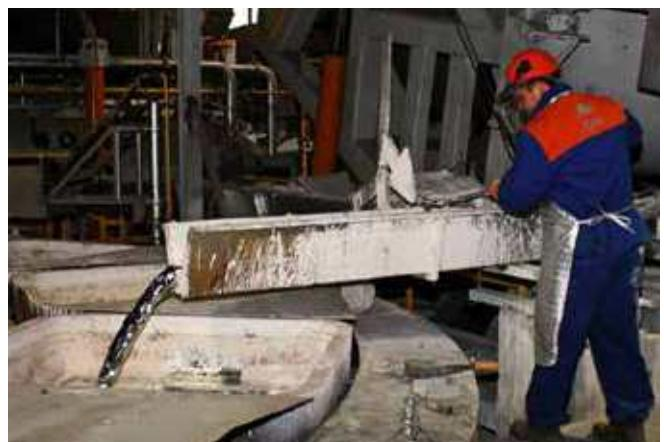
Ispuštanje lijeva iz peći
