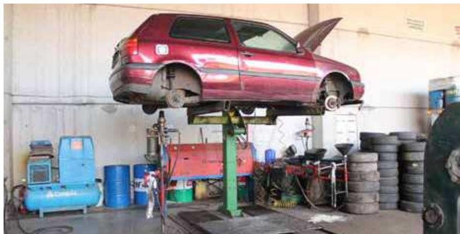
Izrabljeni automobili dopremaju se u ovlaštene centre gdje započinje proces demontaže i pripreme iskoristivih dijelova za daljnju uporabu
