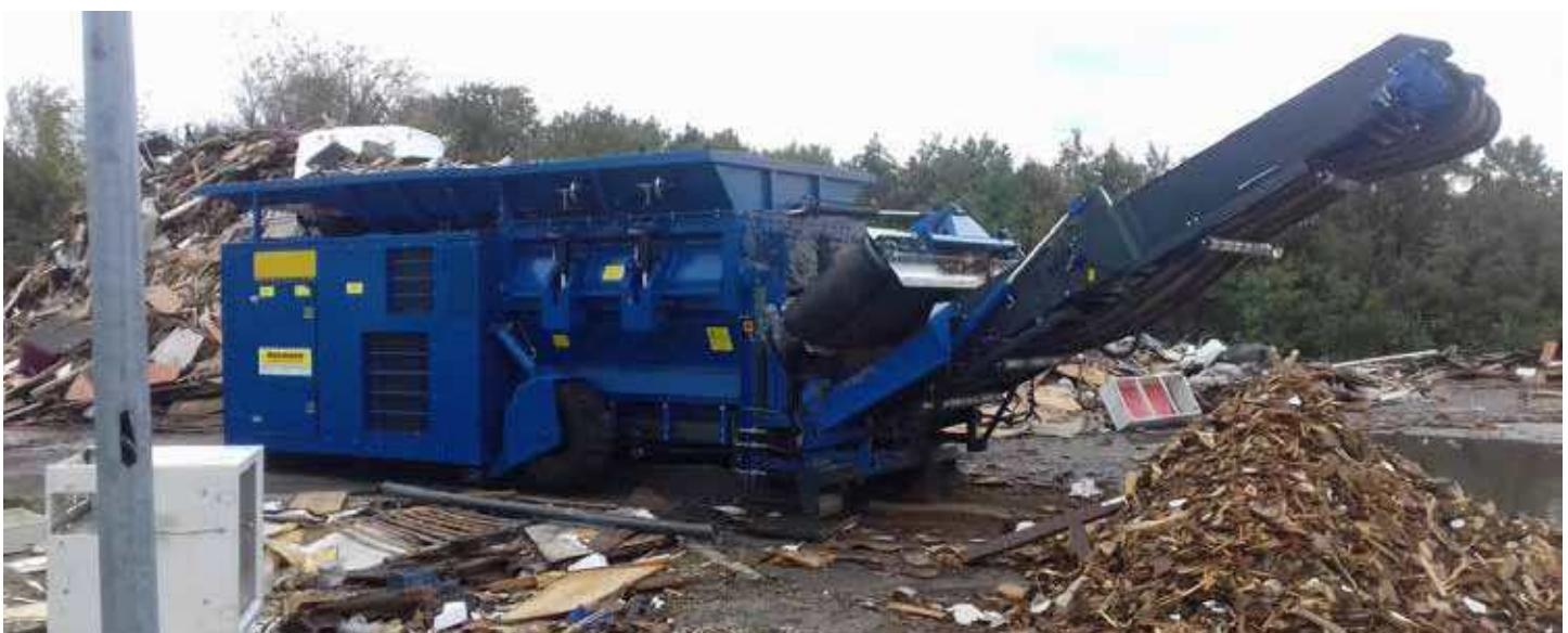
Drveni otpad usitnjava se specijalnim strojevima
