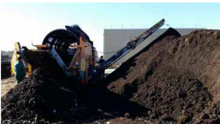
Gotov kompost se prosijava kako bi se iz njega izdvojili ostaci nekompostiranog materijala i eventualne nečistoće (npr. ostaci plastike).
