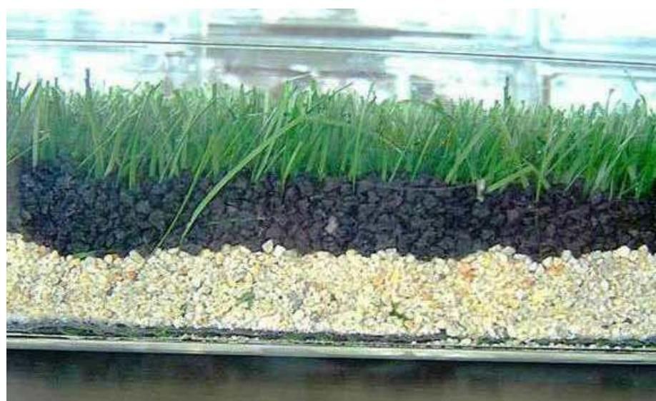
Gumeni granulat – ispuna u umjetnoj travi
