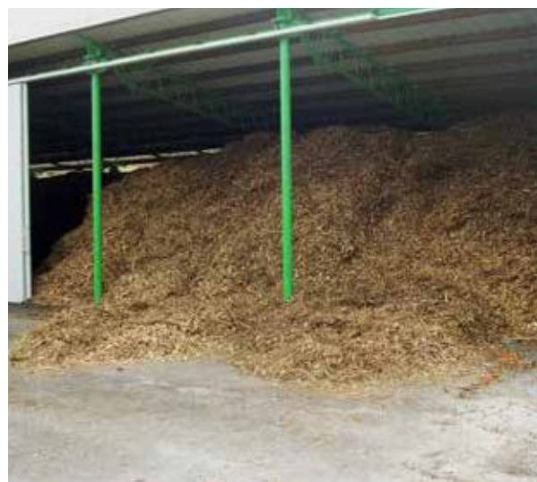
Usitnjeni materijal se odlaže u prozirne prostore radi prirodnog procesa isušivanja
