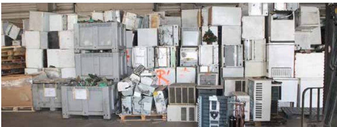
Rashladni uređaji se prije postupka recikliranja moraju skladištiti u suhim, prozračnim prostorima
