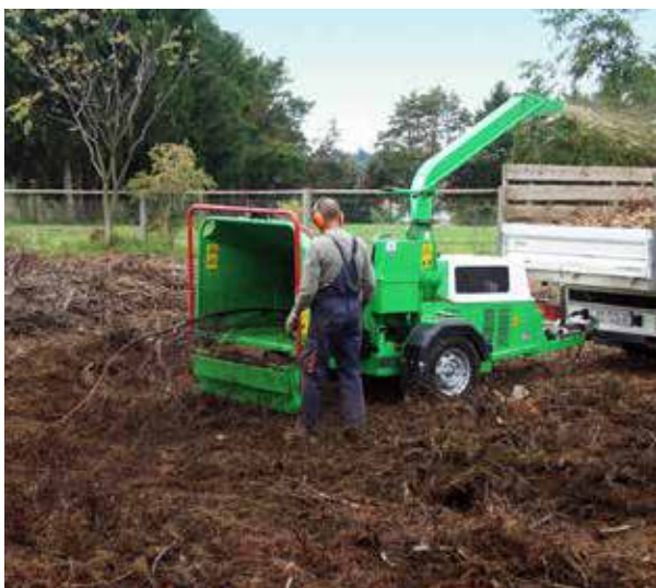
Prije kompostiranja granje se strojno usitnjava - sječkalica
