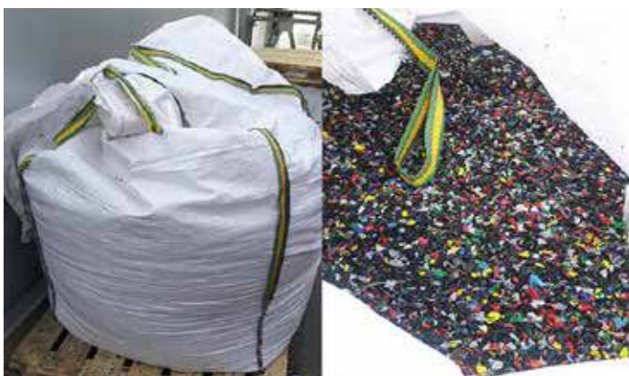
Procesom mljevenja dobivamo novi repromaterijal koji možemo iskoristiti u izradi novih proizvoda. Postrojenje za mljevenje tvrde plastike
