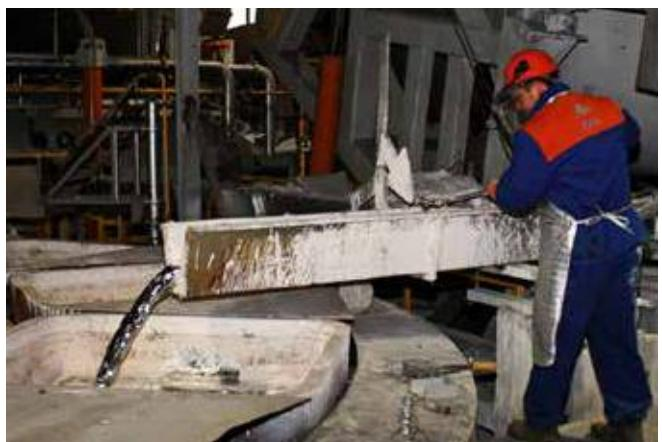
Ispuštanje lijeva iz peći
