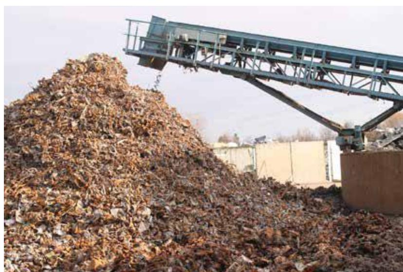
Otprikljike 60 % ukupne mase automobila čini čelični lim. Na slici je prikazana završna frakcija lima iz postupka drobljenja. Lim nakon drobljenja odlazi u ljevaonice i željezare kao sekundarna sirovina te se od njega rade poluproizvodi (ingoti).
