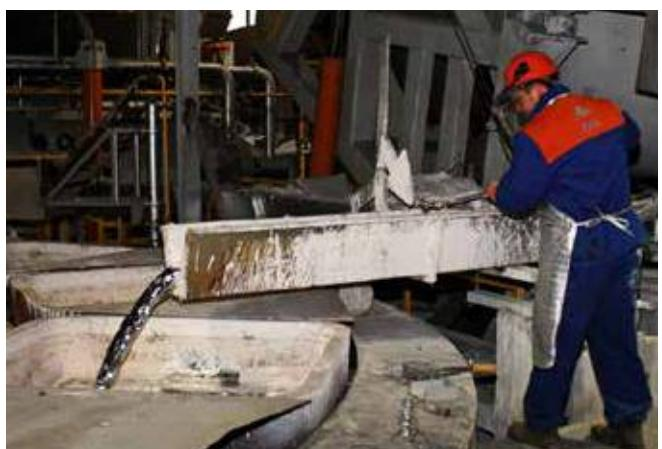
Ispuštanje lijeva iz peći
