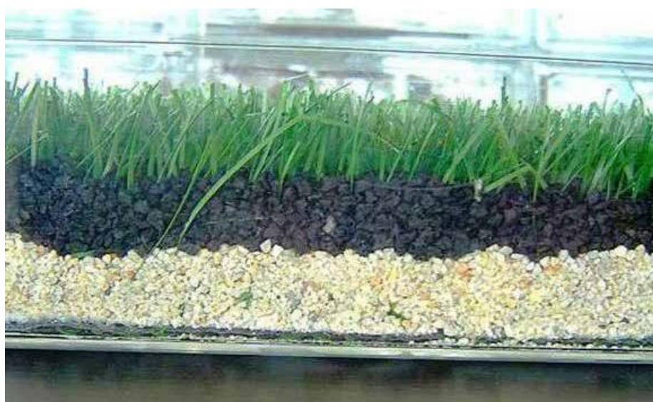
Gumeni granulat – ispuna u umjetnoj travi
