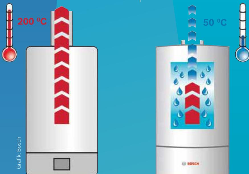
Kondenzacijski kotlovi za grijanje, zahvaljujući i inteligenntnoj tehnologiji, predstavljaju rješenje koje istovremeno štedi energiju i troškove. Pritom, sasvim jednostavno možete gotovo potpuno iskoristiti sadržaj energije korištenog goriva. Toplinsku energiju koja se kod izgaranja, prirodnog plina oslobađa u obliku vodene pare, sustav dobiva natrag postupkom kondenzacije.
