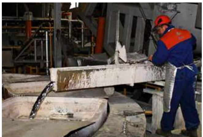
Ispuštanje lijeva iz peći
