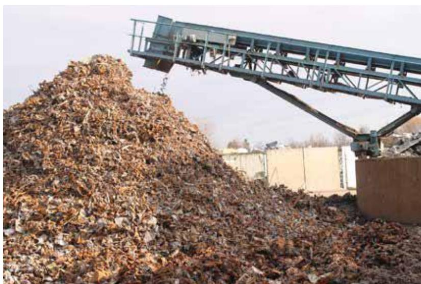
Otpriike 60 % ukupne mase automobila čini čelični lim. Na slici je prikazana završna frakcija lima iz postupka drobljenja. Lim nakon drobljenja odlazi u ljevaonice i željezare kao sekundarna sirovina te se od njega rade poluproizvodi (ingoti).
