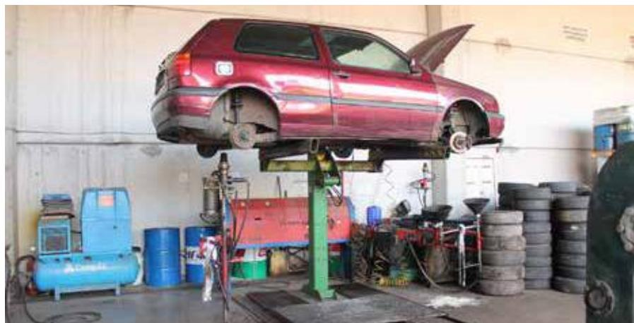
Izrabljeni automobili dopremaju se u ovlaštene centre gdje započinje proces demontaže i pripreme iskoristivih dijelova za daljnju uporabu
