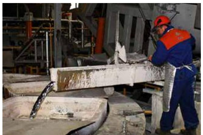
Ispuštanje lijeva iz peći
