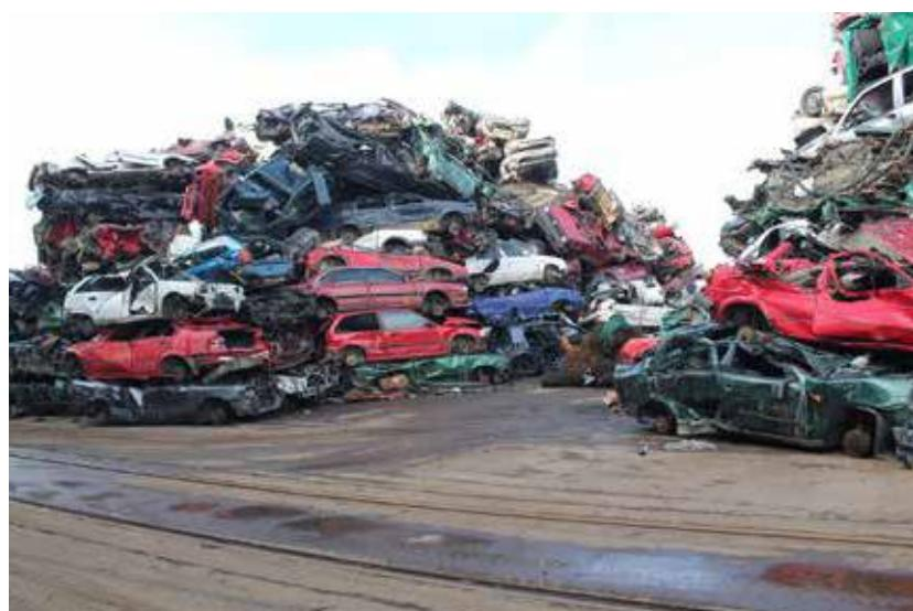
Otpadna vozila nakon prve faze obrade „čekaju“ drugu fazu – mehaničku separaciju drobljenjem na takozvanim šredderima.
