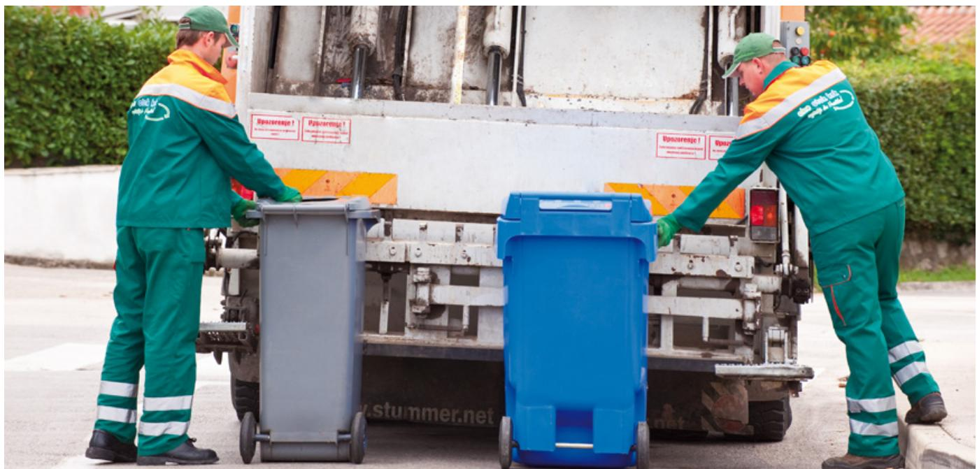
Specijalno vozilo s odvojenim spremnicima za istovremeno prikupljanje dviju vrsta otpada
