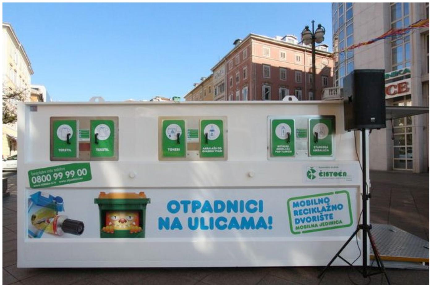
Samostalno mobilno reciklažno dvorište je prenosivo zahvaljujući svojoj strukturi kontejnera dužine 4,7 m, širine 1,95 m i visine 2,1 m, unutar kojega se nalazi 11 spremnika za prikupljanje različitih vrsta otpada (3 spremnika od 1100 litara, 6 spremnika od 240 litara te 2 manja spremnika za prikupljanje lijekova i baterija).
