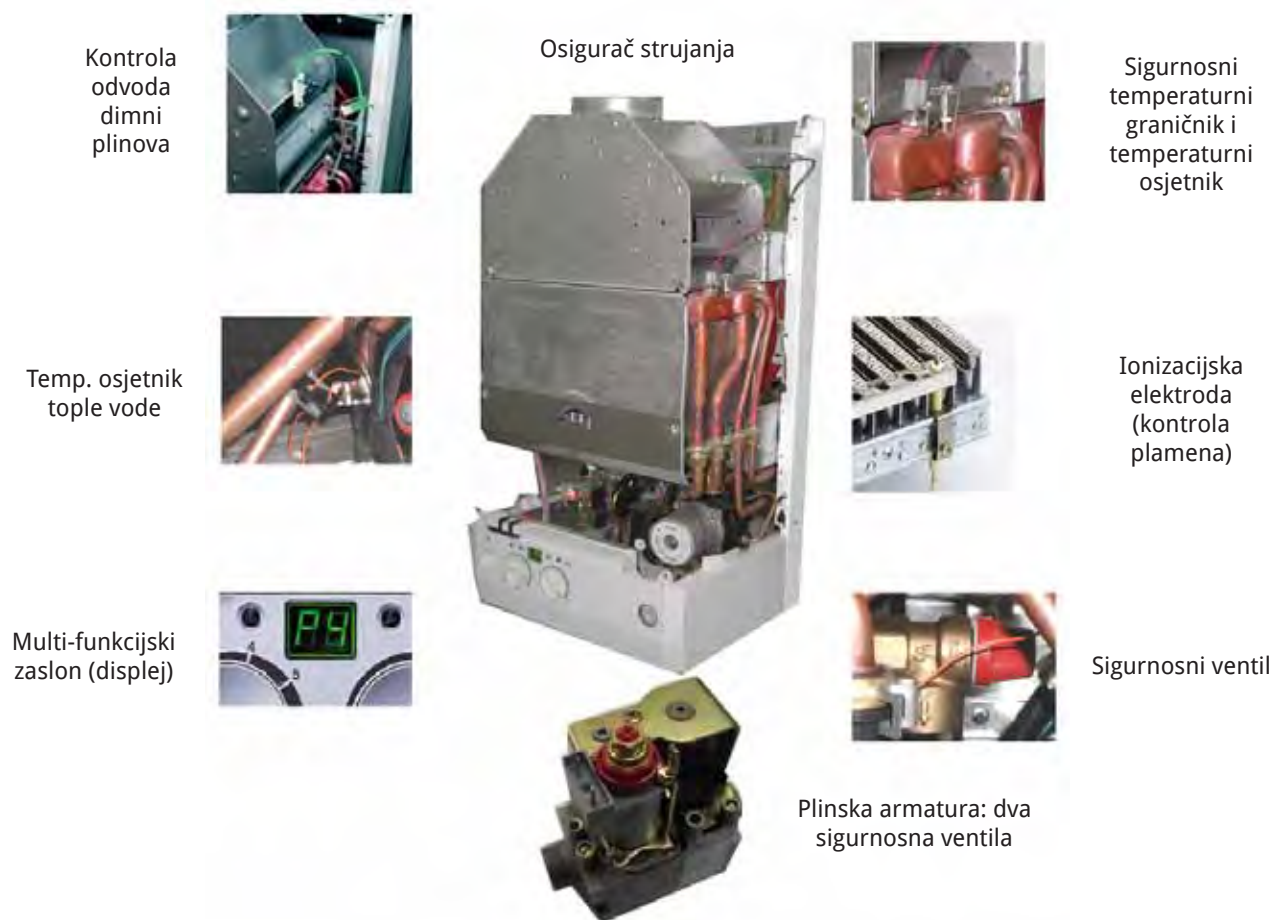
Slika 1. Prikaz sigurnosnih elemenata na uređaju Junkers Eurostar s priključkom na dimnjak
